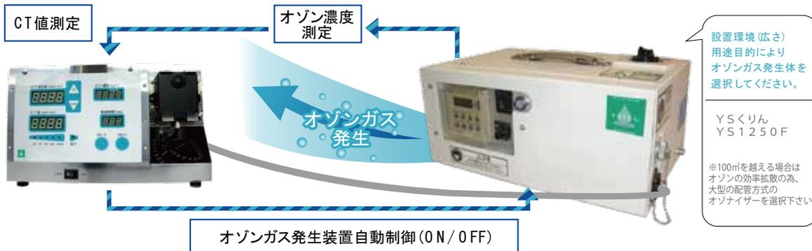
オゾンガス発生装置より発生させたオゾンガスの濃度をCT計の濃度センサーにより測定し、測定されたオゾンガス濃度をCT積算計により稼働時間との積として(いわゆるCT値)表示する。CT計にはあらかじめ必要CT値を設定しておきそのCT値に達した場合は自動でオゾンガス発生装置を停止させる。
