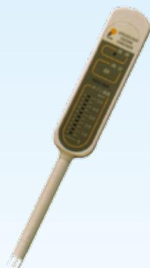
DOC05Aは小型・軽量で携帯に便利な簡易溶存オゾンチェッカーです。採取したオゾン水に電解液を入れセンサを振るだけで簡単に溶存オゾン濃度のチェックが可能です。溶存オゾン濃度は10個のLEDで表示されます。
